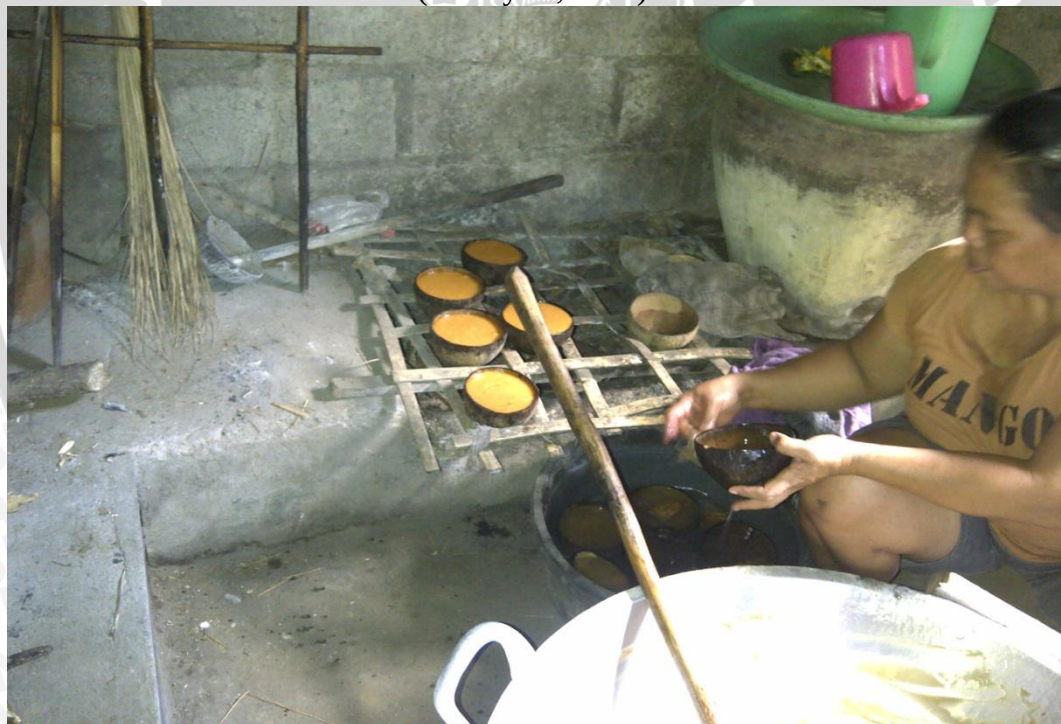
4. Pencetakan gula merah ke dalam batok kelapa
