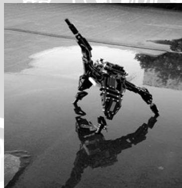
Gambar 2.4. Keseimbangan Robot Saat Mengangkat Satu Kakinya
