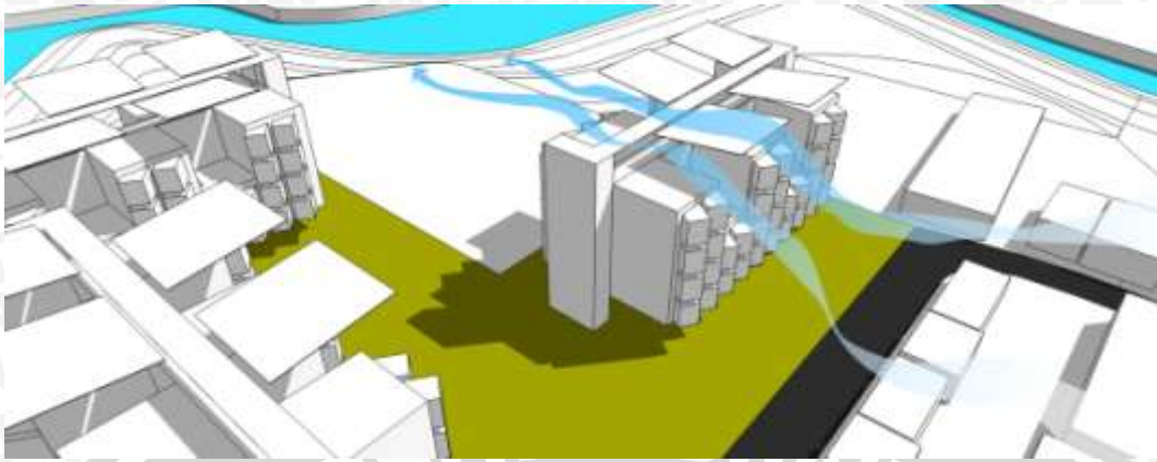
Gambar 4.46 aliran angin melalui Atap sebagai wind scoops
