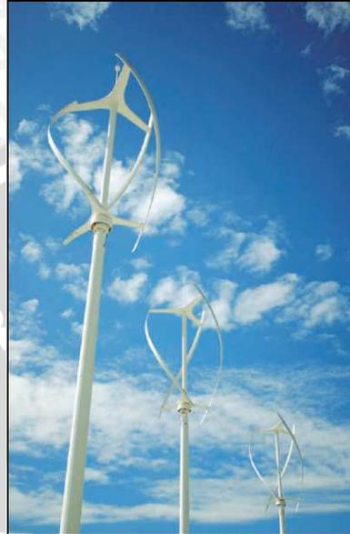
Gambar 2.3 Turbin Angin Sumbu vetikal
