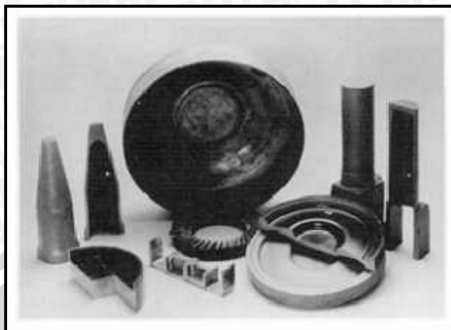
Gambar 2.3 Berbagai jenis part ferrous dan non-ferrous yang dibuat menggunakan pengecoran squeeze .
