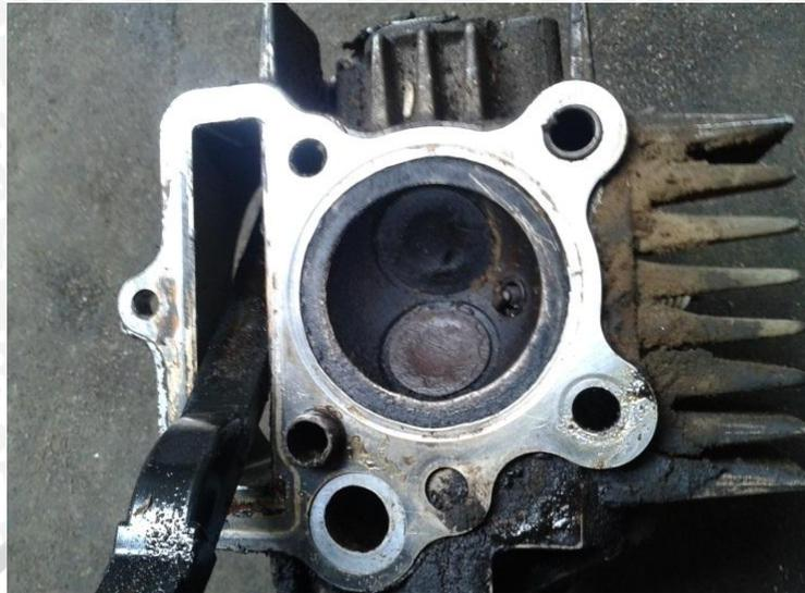
Gambar 2.13 *Intake valve* dan *exhaust valve*
