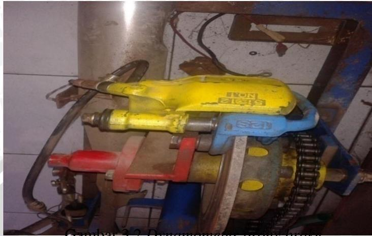
Gambar 3.2 *Dynamometer prony brake*
