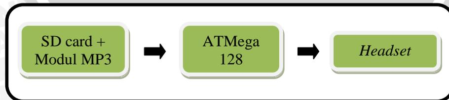
Gambar 5.7. Diagram Blok Pengujian Modul MP3 TDB381
