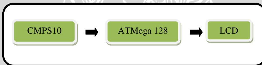
Gambar 5.3. Diagram Blok Pengujian Modul Kompas CMPS10
