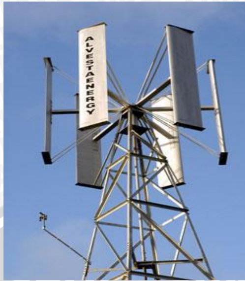
Gambar 2.6: Salah Satu tipe Turbin poros vertikal. Sumber: Daryanto (2007).
