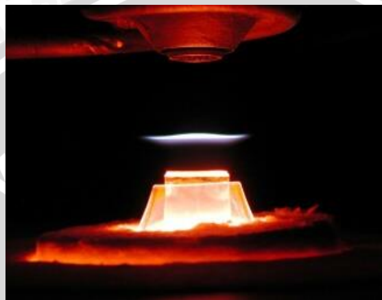
Gambar 2.5: Nyala api pada counterflow burner Sumber: Ukisu Yuji, Kitajima Akio, Hatanaka Takeshi, Takeuchi Masao:2004
