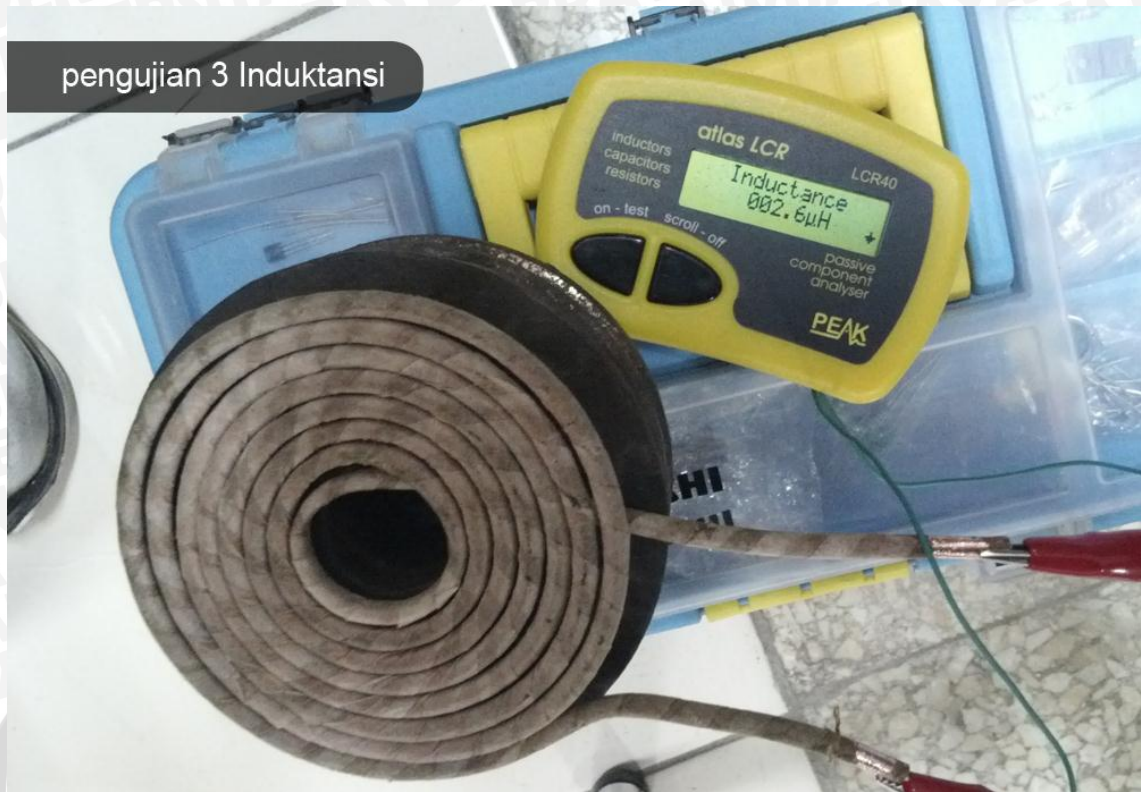
Gambar 5. 4. Pengujian nilai induktansi pancake coil
