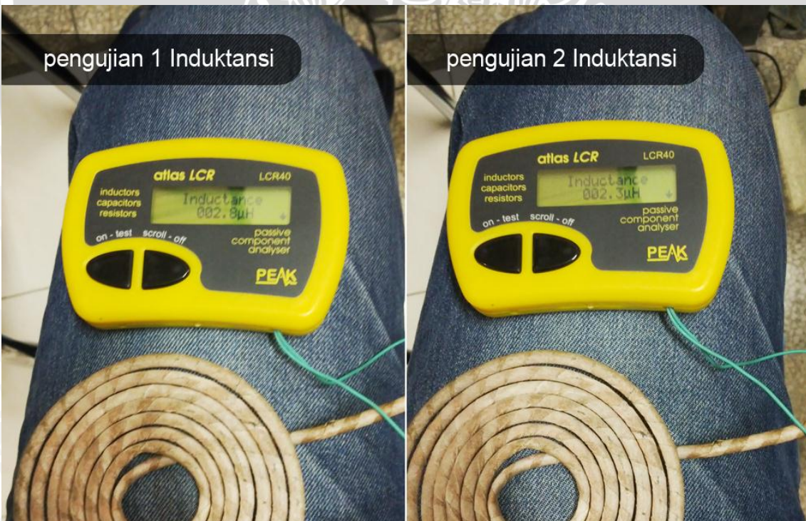
Gambar 5. 3. Pengujian nilai induktansi pancake coil
