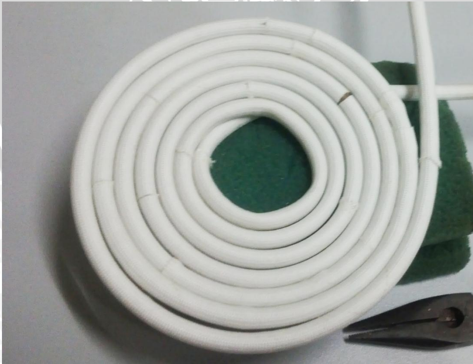
Gambar 4. 5. pancake coil yang digunakan untuk percobaan
