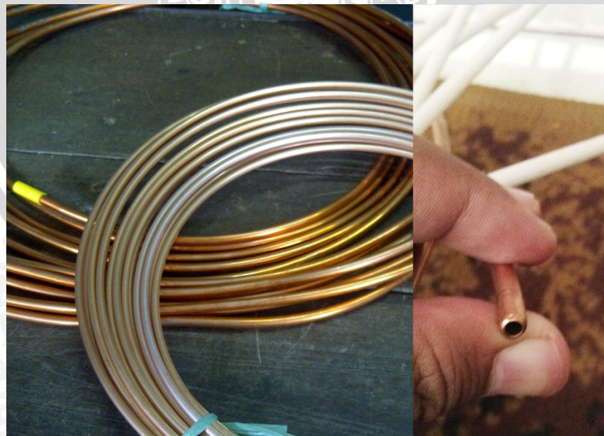
Gambar 4. 2. Pipa tembaga untuk pancake coil
