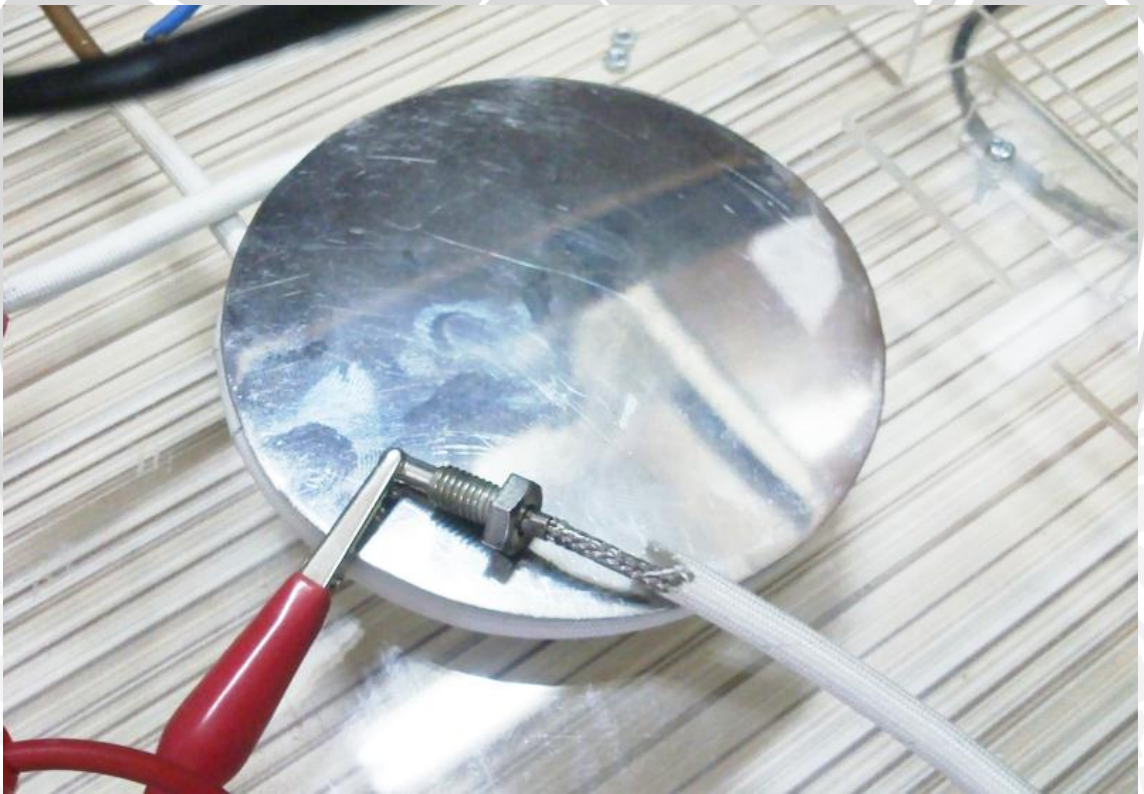
Benda kerja dan thermocouple pada saat pengujian
