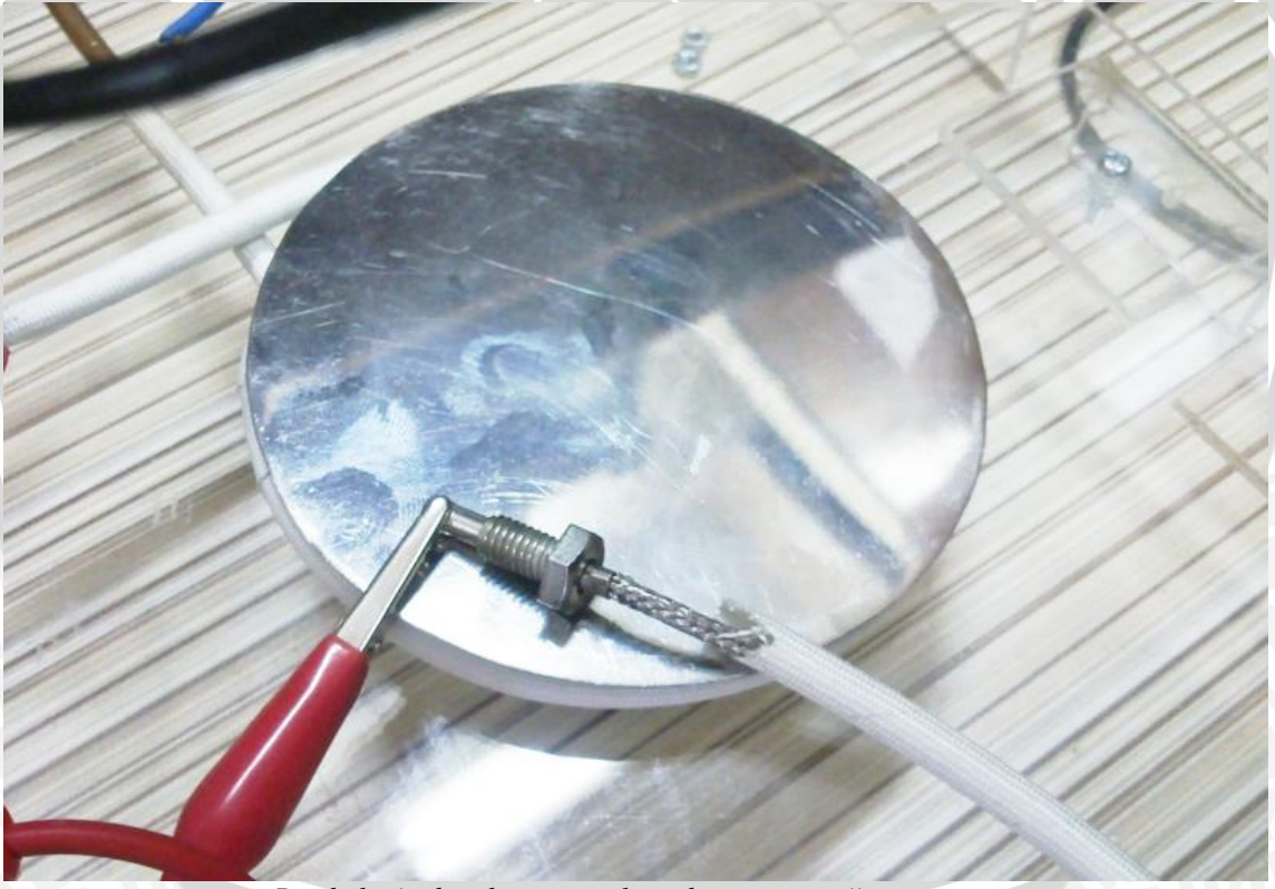
Benda kerja dan thermocouple pada saat pengujian
