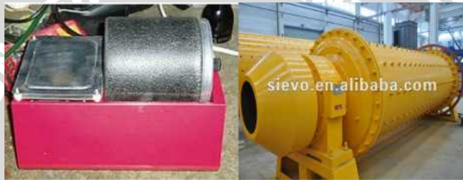
Gambar 2.8 ballmill pada laboratorium dan pabrik Sumber: Anonymous4.2013
