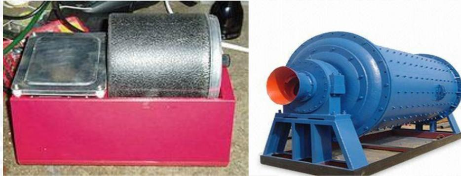
Gambar 2.2 *Ballmill* yang Digunakan Dilaboratorium dan Dipabrik
