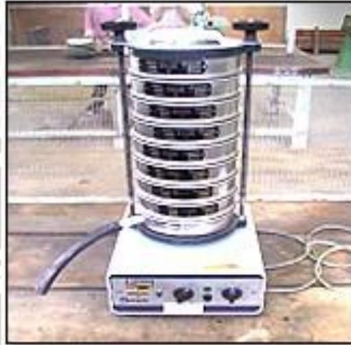
Gambar 3.3 Mesin Pengguncang Rotap
