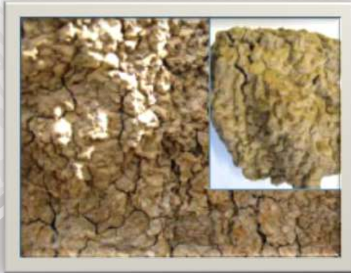
Gambar 2.5. 'lubang cacing' atau pola retakan pada tanah dispersif. Sumber : Hardie, 2009b
