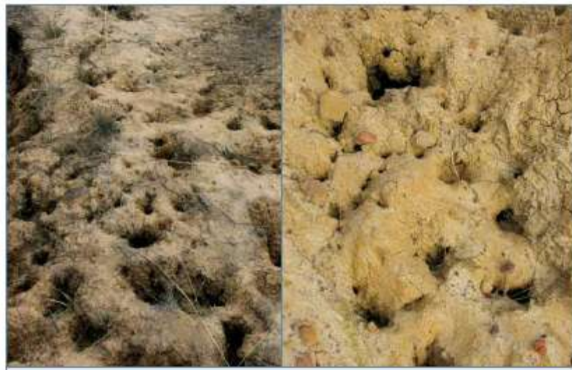
Gambar 2.5. Pitting dan pocketing pada tanah dispersif. Sumber : Hardie, 2009b
