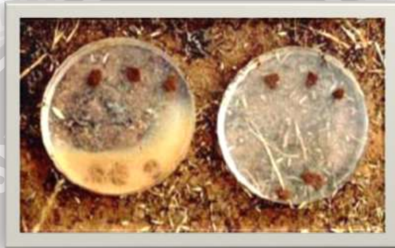
Gambar 2.7. Pengamatan tanah dispersif dilapangan. Sumber : Hardie, 2009a
