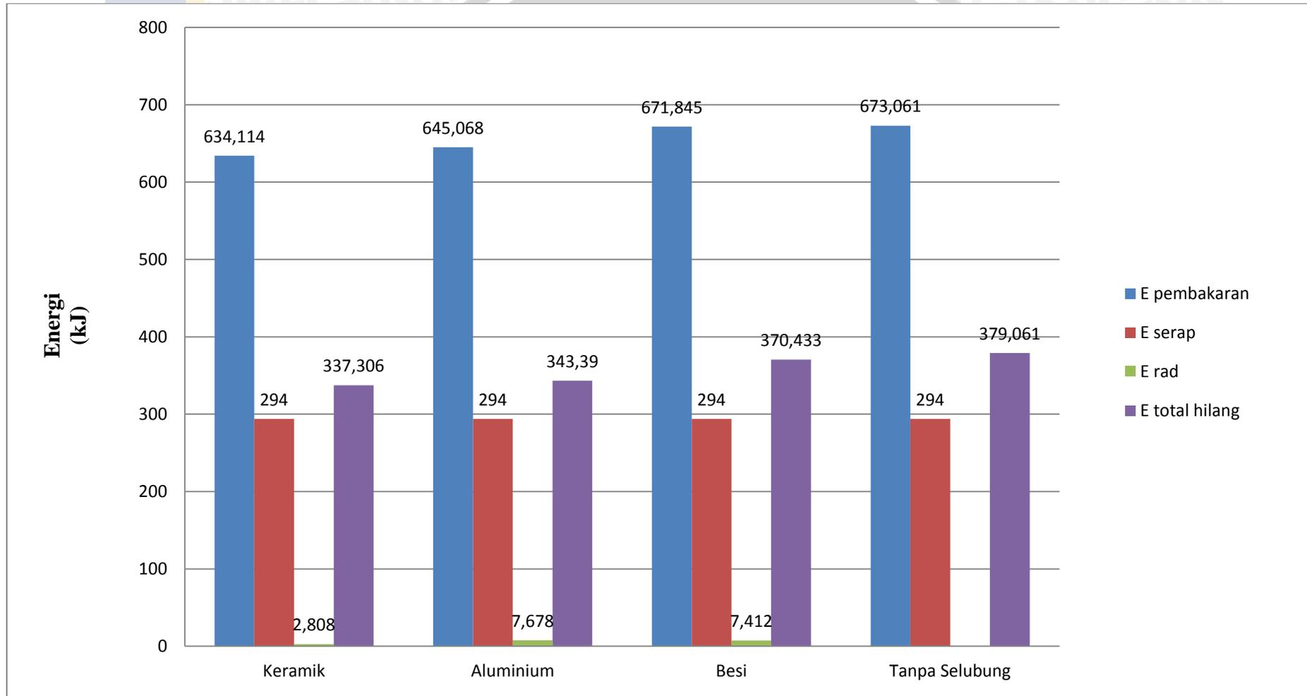
Gambar 4.4 Grafik Disitribusi Energi Panas Kompor Gas Dengan Variasi Selubung.
