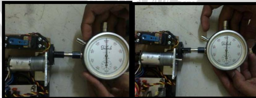
Gambar 5.3 Pengukuran kecepatan motor kanan dengan masukan sinyal PMW 100% menggunakan tachometer analog.
