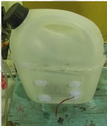
Gambar 2.5 Perangkap gas dengan pengkondisian tertutup
