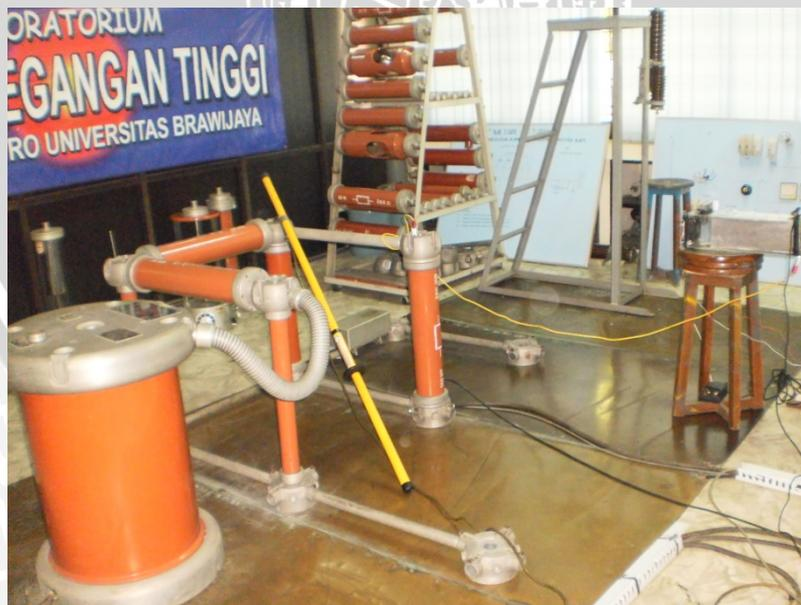
**Gambar 5.1 Rangkaian Percobaan dan Pengujian Model Miniatur EP**
