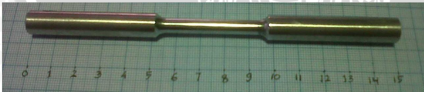
Spesimen pengujian tarik dengan penekanan 50 MPa
