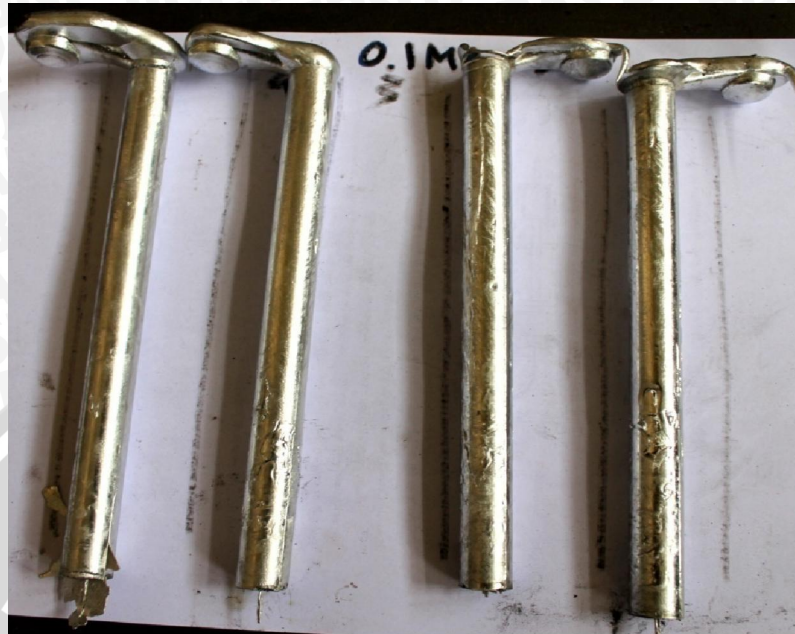
Spesimen dengan penekanan 0,1 MPa
