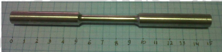
Spesimen pengujian tarik dengan penekanan 0.1 MPa
