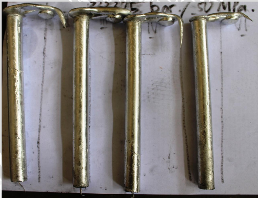
Spesimen dengan penekanan 50 MPa
