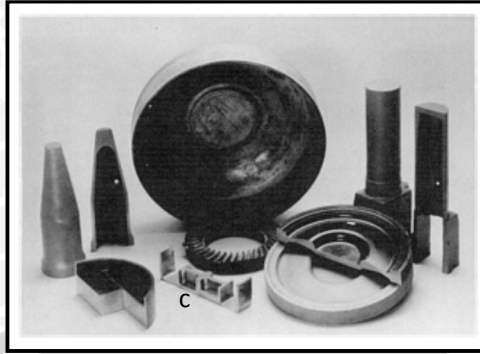
Gambar 2.4 : Berbagai jenis part ferrous dan non-ferrous yang dibuat menggunakan pengecoran squeeze .
