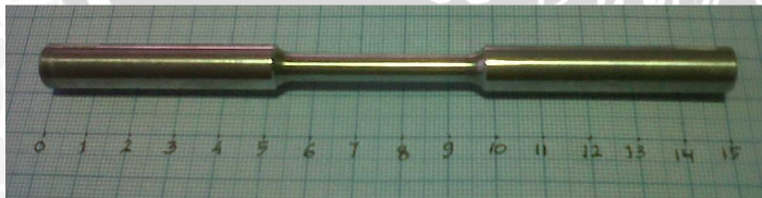
Spesimen pengujian tarik dengan penekanan 10 MPa
