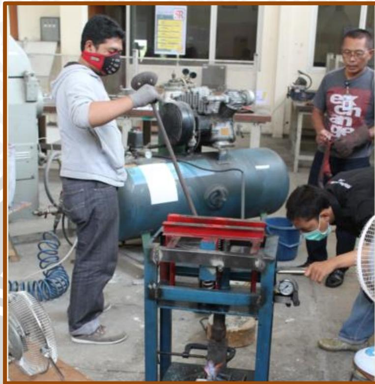
Proses Pengecoran *Squeeze*
