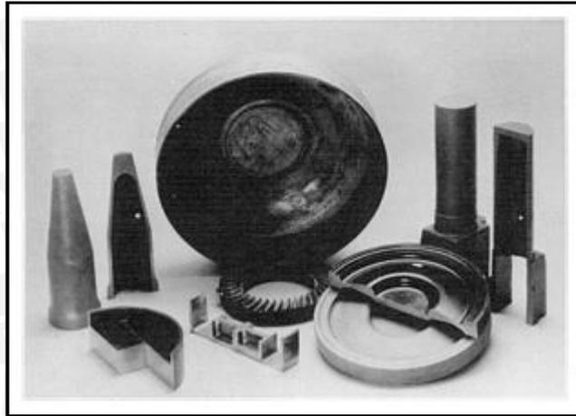
Gambar 2.3 Berbagai Jenis Part *Ferrous* dan *Non-Ferrous* yang Dibuat Menggunakan Pengecoran *Squeeze*.
