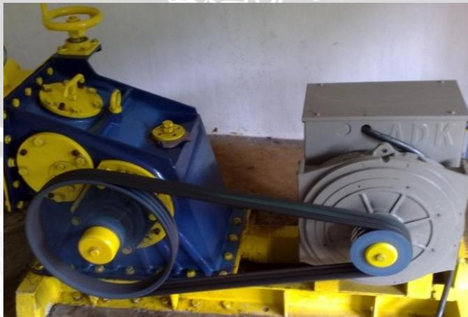
Gambar 2.9 Transmisi Mekanik
