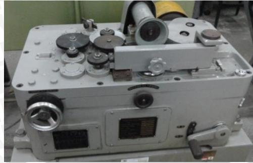
Gambar 2.7 Alat Uji Keausan
