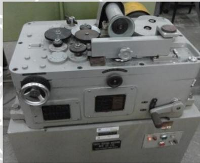
Gambar 3.6 Alat Uji Keausan
