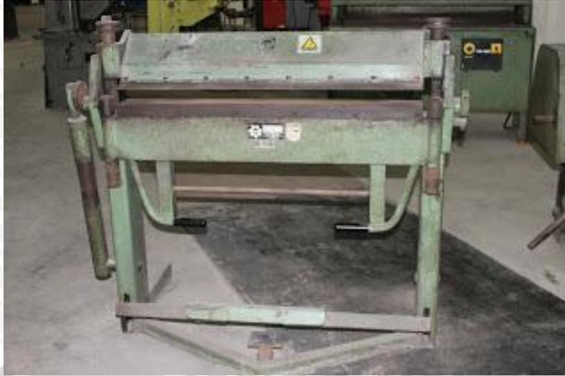
Gambar 3.3 Mesin Penekuk Pelat
