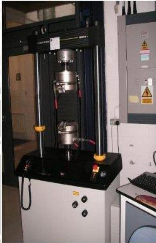
Gambar 3.3 Mesin Uji *Fatigue*
