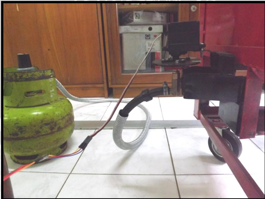
Gambar 3 Foto Pemasangan Motor Servo pada Valve Burner
