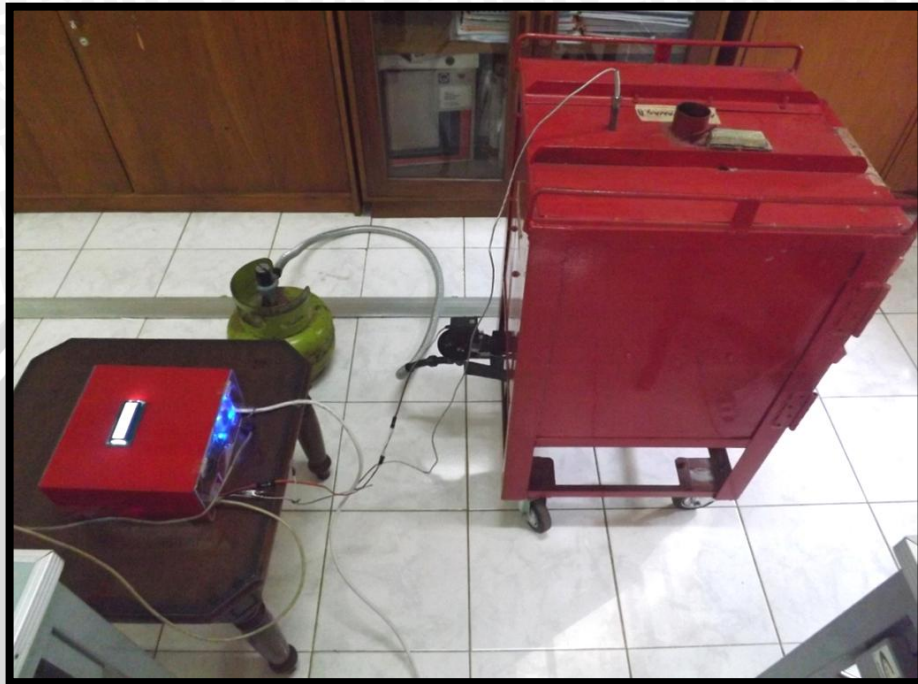
Gambar 1 Foto Tungku dan Kotak Kontroler Tampak Samping
