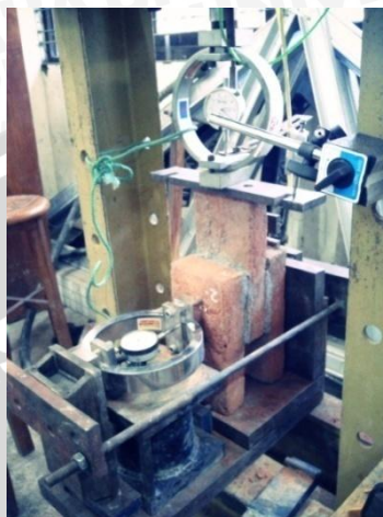
Gambar 4.8 Pengujian Kuat Geser Batu Bata
