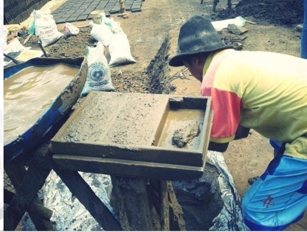
Gambar 4.3 Pencetakan Batu Bata
