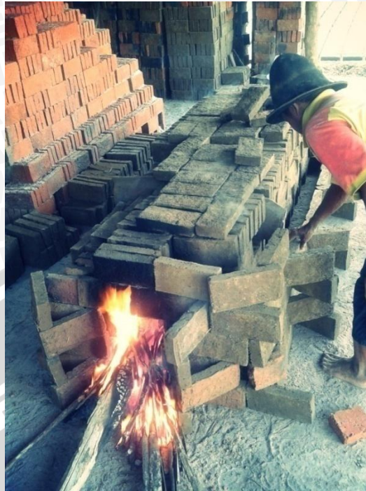
Gambar 4.5 Proses pembakaran batu bata
