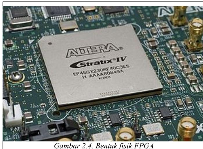
Gambar 2.4. Bentuk fisik FPGA
