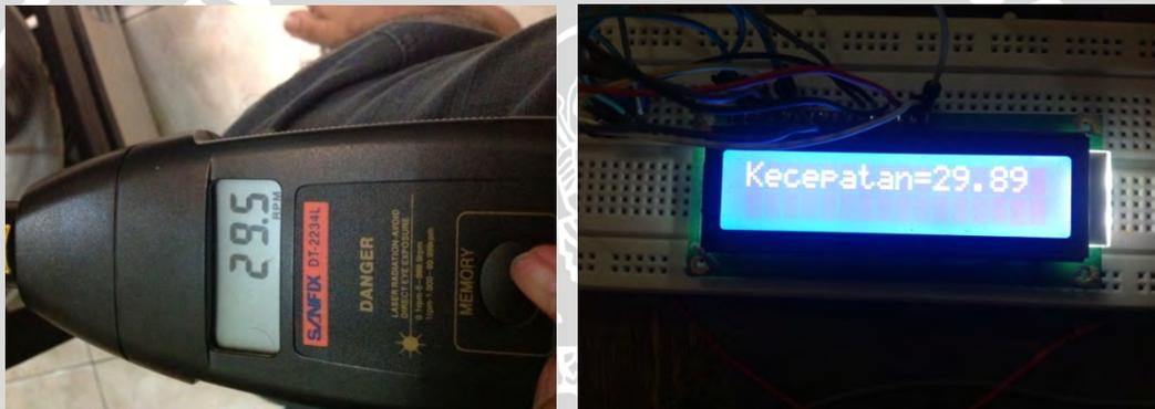
Gambar 4.4. Putaran terukur motor dengan menggunakan tachometer dan *rotary encoder*
