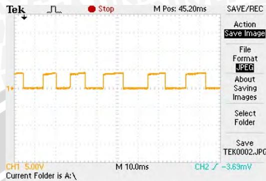
Gambar 4.3. Tegangan keluaran dari sensor *rotary encoder*
