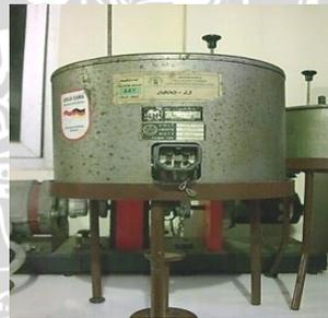
Gambar 3.6 : Viskometer
