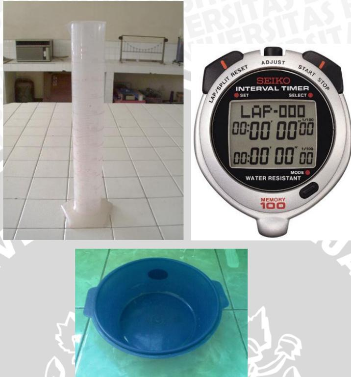
Gambar 3.8 Gelas ukur, penampung air dan *stopwatch*
