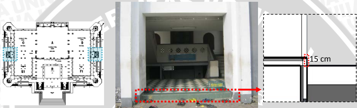
Gambar 4.55 Level ketinggian yang berbeda antara lantai suci dan najis pada perbatasan ruang luar dan bordes tangga dalam menuju tempat wudhu
