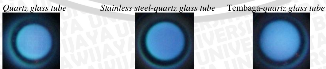
Gambar 4.5 Visualisasi api dalam combustor tanpa isolator pada V_{tot} = 53.4 cm/s dan \Phi = 1 .
