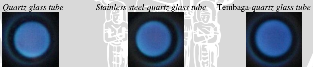
Gambar 4.10 Visualisasi api dalam combustor tanpa isolator pada rasio ekuivalen (\Phi) = 1 .
