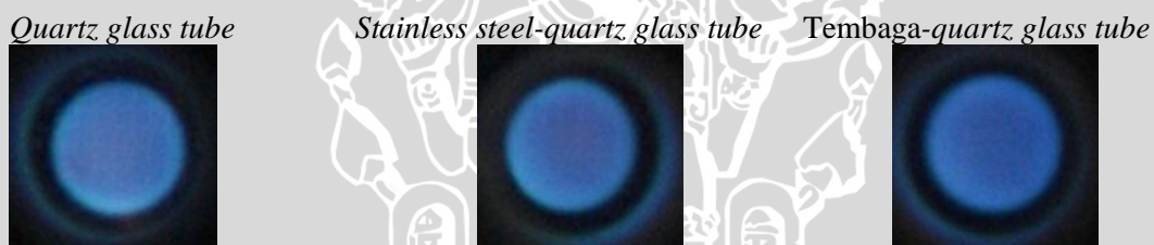
Gambar 4.3 Visualisasi api dalam combustor tanpa isolator pada V_{tot} = 38.9 cm/s dan \Phi = 1 .
