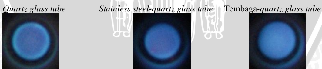
Gambar 4.4 Visualisasi api dalam combustor dengan isolator pada V_{tot} = 38.9 cm/s dan \Phi = 1 .
