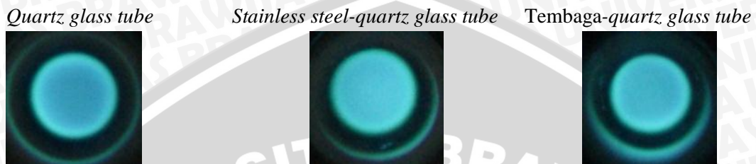
Gambar 4.13 Visualisasi api dalam combustor dengan isolator pada rasio ekuivalen ( \Phi ) = 1.26.
