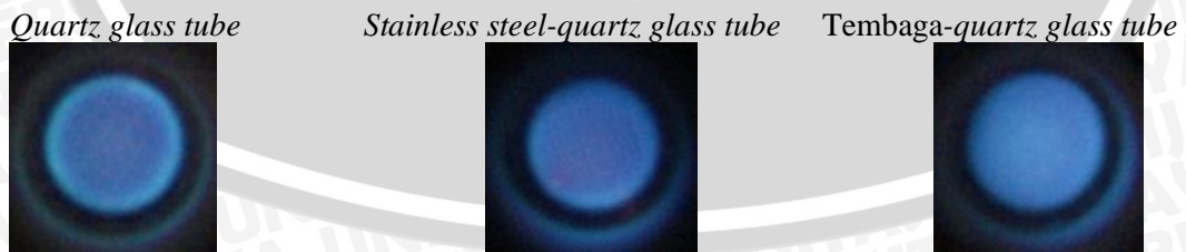
Gambar 4.11 Visualisasi api dalam combustor dengan isolator pada rasio ekuivalen (\Phi) = 1 .
