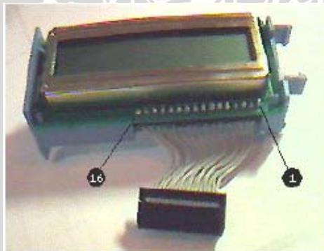
Gambar 2.11 LCD 16X2
