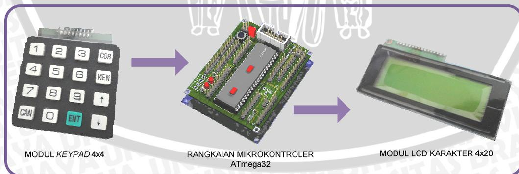
**Gambar 5.1** Diagram Blok Pengujian *Keypad* dan Modul LCD
