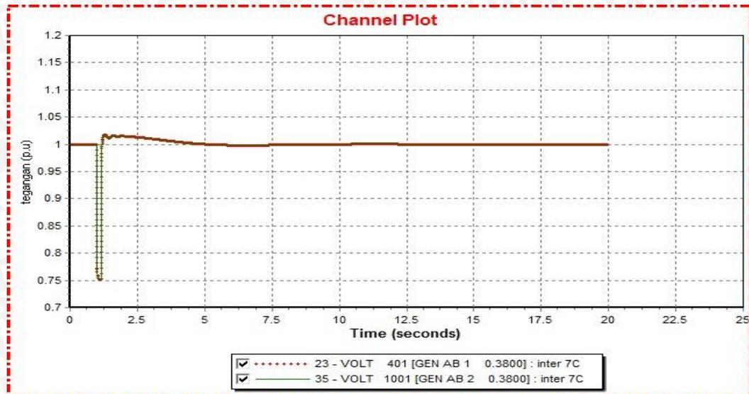
Gambar 4.20 Grafik tegangan =  $f(t)$  setelah interkoneksi pada bus GEN AB1 dan bus GEN AB2 saat diberikan gangguan pada bus load 3B
