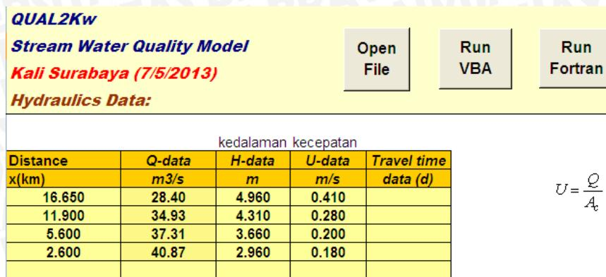
Gambar 4.24 Lembar kerja *Hydraulics Data*
