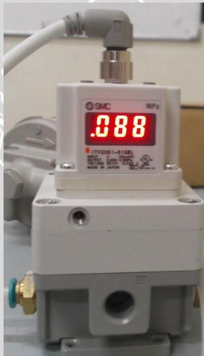
Gambar 4.4 Tampak depan ITV3051-013B
