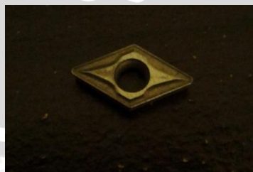
Gambar 3.3 Pahat karbida merk TIZIT tipe DCMT 070204EN
