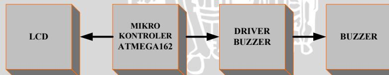
Gambar 5.8. Diagram Blok Pengujian *Driver Buzzer* dan *Buzzer*
