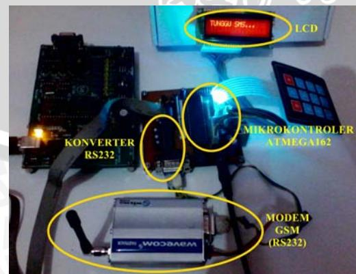
Gambar 5.14. Pengujian Modem GSM
