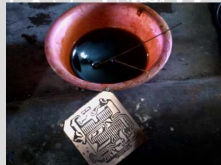
Gambar 4.27. Proses Pelarutan PCB
