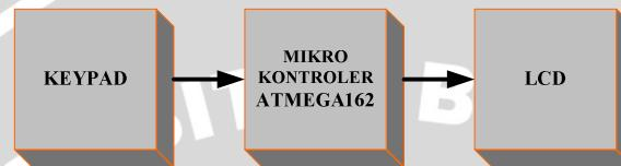
Gambar 5.4. Diagram Blok Pengujian Keypad
