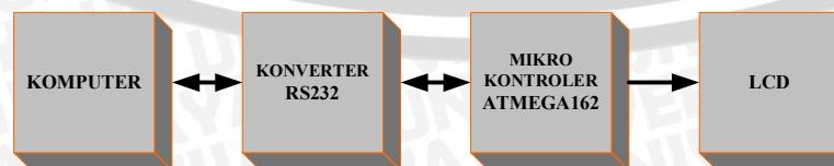
Gambar 5.10. Diagram Blok Pengujian Konverter RS232
