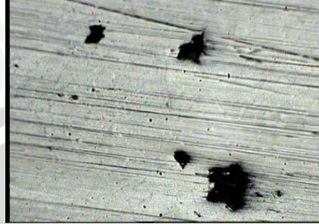
Gambar 4.6. Porositas yang Terjadi pada Temperatur 490^{\circ}\text{C} Permukaan Atas
