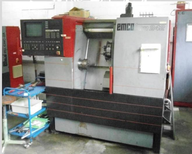
Gambar 3.1 : Mesin Bubut CNC
