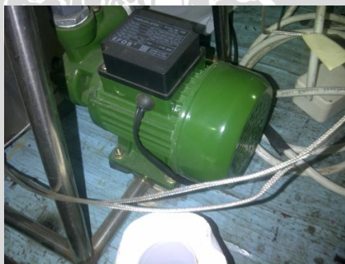
Gambar 3.2 Unit pompa air sentrifugal
