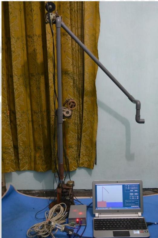
Gambar 5.16 Pengujian Keseluruhan Sistem Monitoring *Loading Arm*
