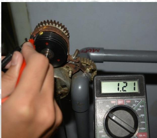
Gambar 5.2 Pengukuran Tegangan Modul Sensor Potensiometer dengan  $\theta=90^\circ$
