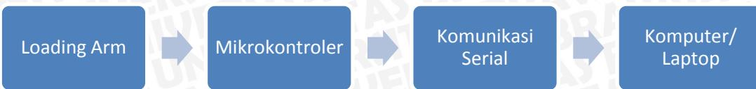
Gambar 5.15 Diagram Blok Pengujian Keseluruhan Sistem
