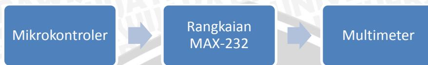
Gambar 5.9 Diagram Blok Pengujian Rangkaian MAX-232
