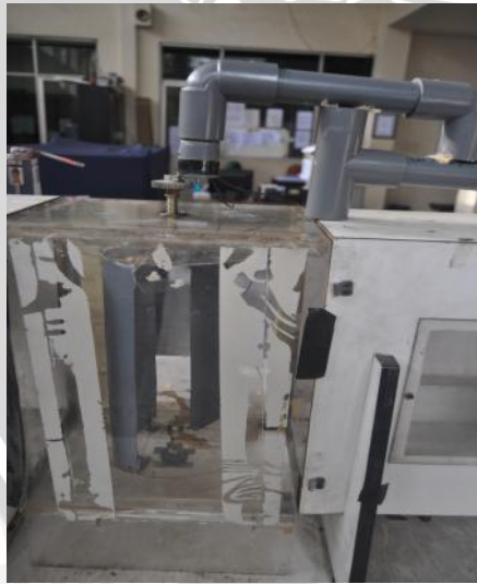
Gambar : Foto persiapan pengujian turbin angin savonius type L dalam wind tunnel
