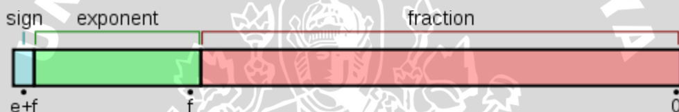
Gambar 2.1. Tiga bidang float dalam format IEEE 754
