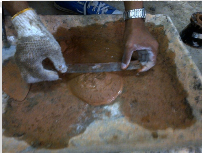
Gambar 4.2 Pengujian Konsistensi Mortar
