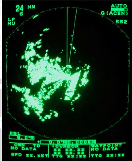
Gambar 5.23. Tampilan *Display* Radar Furuno Dengan *Gain* 1/2 Skala
