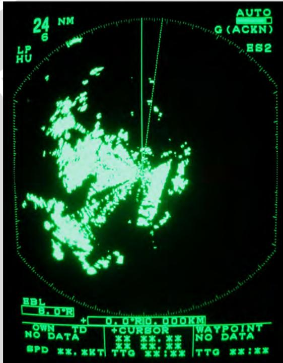
Gambar 5.40. Tampilan *Display* Radar Furuno Dengan *A/C Rain* ¼ Skala
