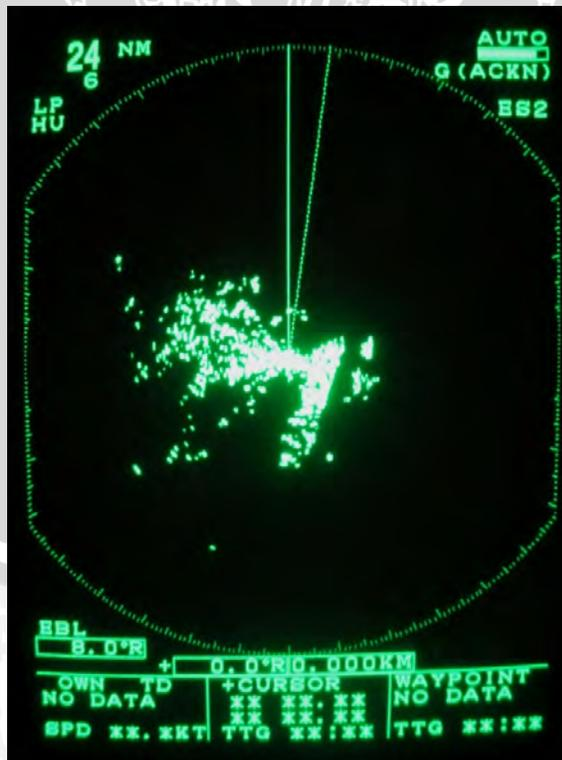
Gambar 5.22. Tampilan *Display* Radar Furuno Dengan *Gain* ¼ Skala
