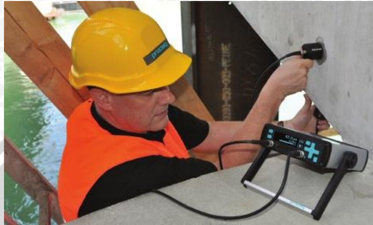
Gambar 1.1 NDT dengan Uji UPV (Sumber : Manual Pundit Lab +, 2011)
